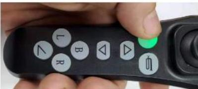
c) Drücken Sie die Geschwindigkeitstaste am Joystick, bis die mittlere Lampe leuchtet.
