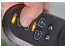
e) Drücken Sie die Abwärtsfeiltaste an der Fernbedienung, bis die Einschalttaste auf der Fernbedienung nicht mehr blinkt.
