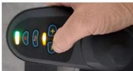
d) Drücken Sie die Hupentaste, um die Geräte automatisch zu koppeln.
