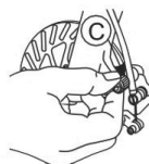
Abb. 15 Einstellung der Scheibenbremsbeläge
