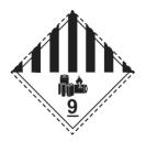
注:该样品为锂离子电池组,瓦特额定值大于一小时 100wh,内含 10 串 5 并共 50 个电芯,并通过 UN 38.3 要求的各项试验。电池具有防止反向电流造成危险所需的有效装置。锂电池需装有安全排气以及防止外部短路的有效装置,并有高质量的管理方案才可按上述条目运输。锂电池必须完全封装在内包装内,位于坚固的外包装中。包装件必须满足 II 级包装的性能要求。
